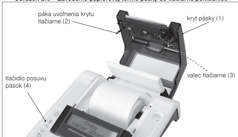
Obrázok 2.6 – Zavedenie papierovej termo pásky do tlačiarne pokladnice
