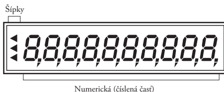
Obrázok 2.5 Rozdelenie segmentového LCD displeja
